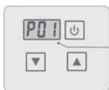
Błąd czujnika temperatury wody wejściowej
